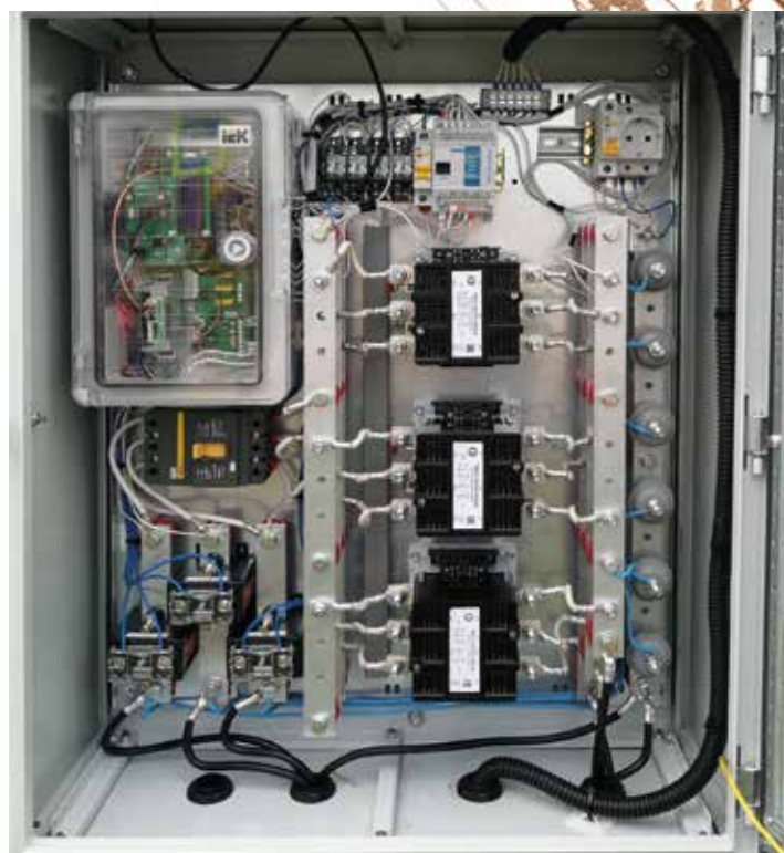
Опытный образец устройства выравнивания нагрузки для трехфазных распределительных сетей
